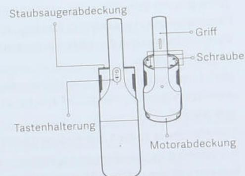
Entfernen Sie die U-Schutzabdeckung und lösen Sie die vier Schrauben an der Abdeckung mit einem Schraubendreher. Schneiden Sie mit einer Schere das Weißblech ab, das den Akku mit der Leiterplatte verbindet.
