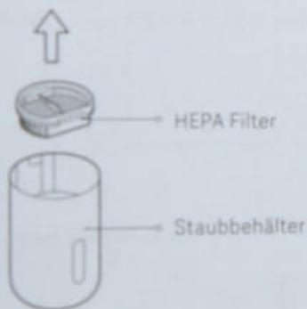
3. Klappen Sie den Griff des Zyklonabscheiders über den Abfalleimer, um den Zyklonabscheider aus dem Staubbehälter zu entfernen, wie in der Abbildung gezeigt. Entleeren Sie den Inhalt des Staubbehälters und entfernen Sie jeglichen Staub von der Oberfläche des Zyklonabscheiders.
