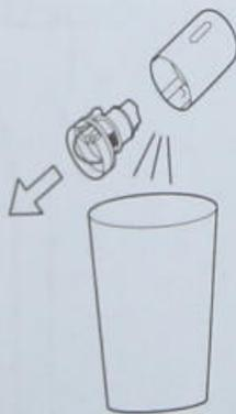
Setzen Sie den Zyklonabscheider und HEPA-Filter wieder in den Staubbehälter ein, wenn die Reinigung abgeschlossen ist. Richten Sie das Verriegelungssymbol „δ“ mit „o“ aus und drehen Sie dann den Staubbehälter in die in der Abbildung gezeigte Richtung, bis „o“ mit dem Verriegelungssymbol „δ“ ausgerichtet ist. Sobald Sie ein Klicken hören, ist der Staubbehälter fest am Staubsauger montiert.
