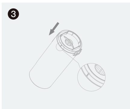
3. Lắp bộ lọc HEPA và bộ lọc Foam vào đúng vị trí hộp bụi
