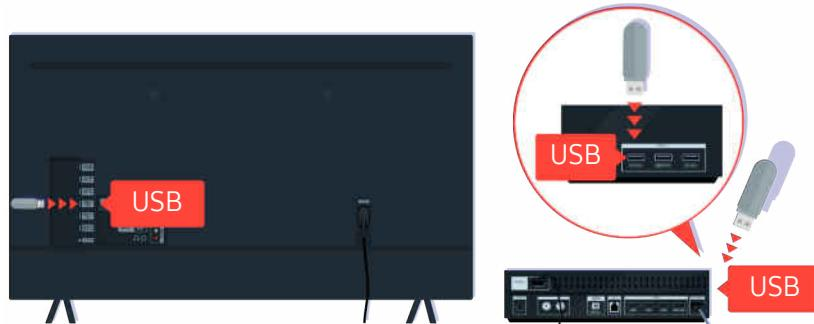
Cắm thiết bị USB vào khe cắm USB ở mặt sau TV hoặc bên cạnh Hộp One Connect.
