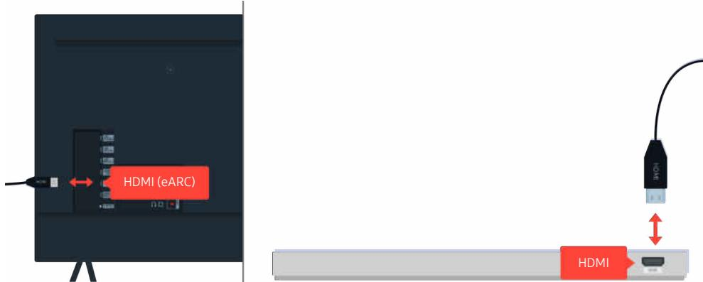
Nếu không có âm thanh phát ra từ loa Soundbar và loa được kết nối với TV bằng cáp HDMI, hãy kiểm tra đầu nối HDMI (eARC) ở phía sau TV.
