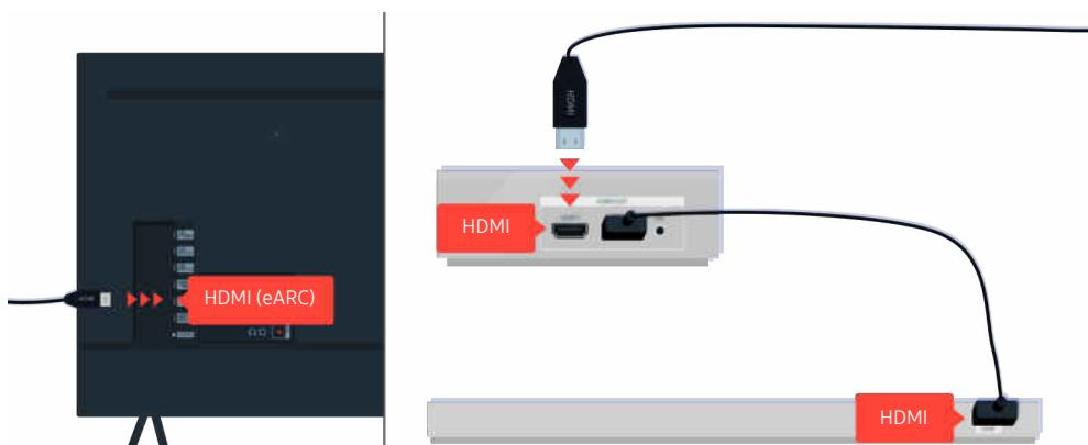
Nếu loa Soundbar được kết nối với bộ thu và bộ thu được kết nối với TV bằng cáp HDMI, hãy kiểm tra đầu nối HDMI ở mặt sau của TV. Cáp phải được kết nối với cổng HDMI (eARC) trên TV.
