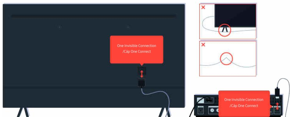
Ngắt kết nối và kết nối lại One Invisible Connection hoặc Cáp One Connect giữa TV và Hộp One Connect. Đảm bảo rằng One Invisible Connection hoặc Cáp One Connect không bị chèn ép hoặc bị gập.
