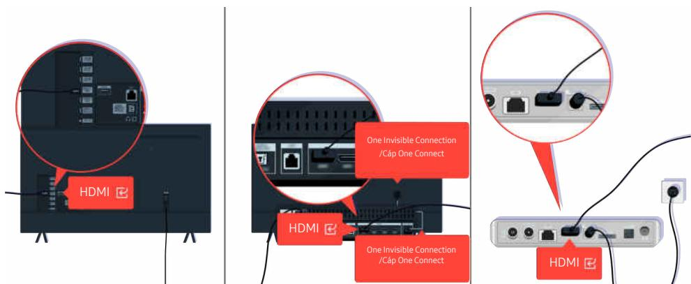
Kiểm tra kết nối của cáp HDMI với TV hoặc Hộp One Connect
