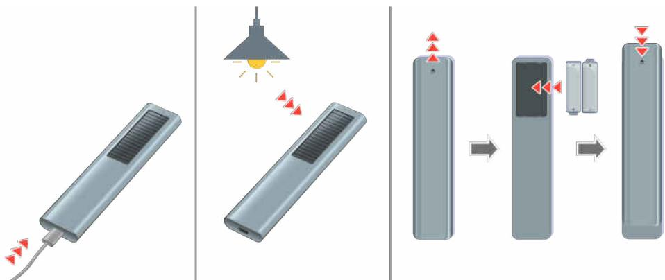
Nếu bạn không thấy tín hiệu hồng ngoại, hãy sạc điều khiển từ xa bằng cách sử dụng cổng USB (loại C) ở phía dưới hoặc lật điều khiển từ xa để sạc bằng pin năng lượng mặt trời. Nếu điều khiển từ xa có pin, hãy thay pin mới.
