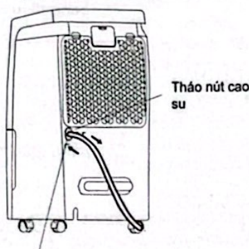
Lắp ống vào đầu ra ống thoát nước.
