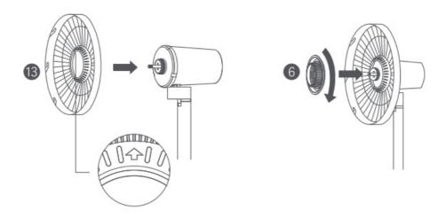
Step 4: Install the fan blade assembly
